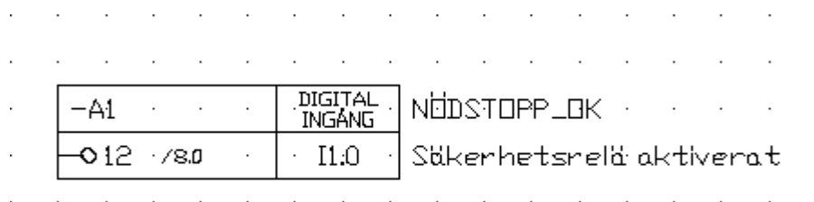
Bild 6. Kretsschema med PLC-spegelsymbol med bara en I/O-punkt
